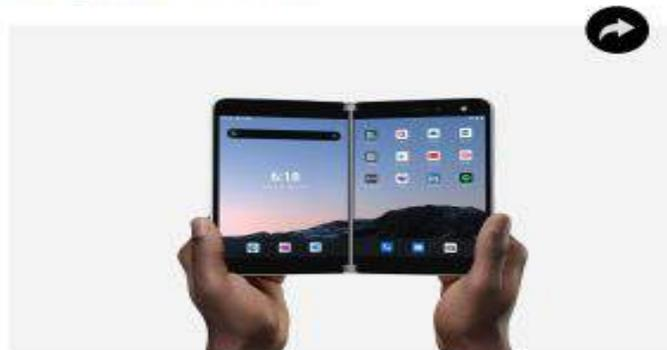
Microsoft ha lanzado su **Surface Duo**; dispositivo móvil que incorpora **dos pantallas** de 5,6 pulgadas unidas por bisagras, lo que supone una diagonal de 8,1 pulgadas que puede utilizarse a modo de tablet.
